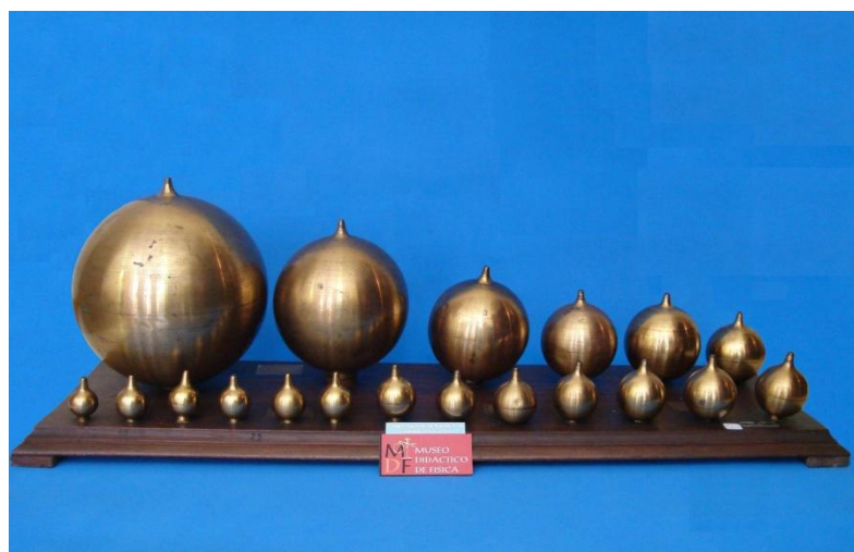
Fig. 73 (resonadors de Helmholtz de freqüències diferents)
